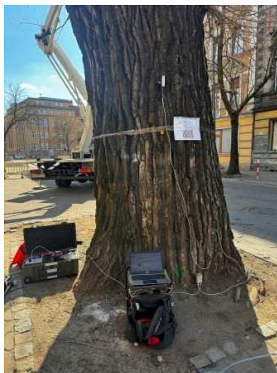
Widok drzewa oraz zainstalowane elastometry i inklinometry
